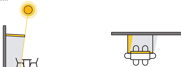
Dimensiones insuficientes para sombrear el espacio.
